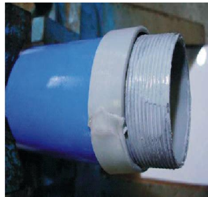
聚四氯乙烯生料缠绕螺纹
