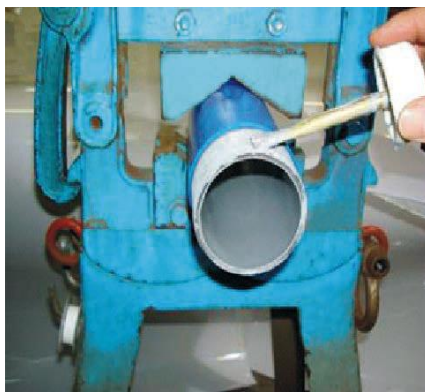
管端部分涂抹自来水用液体粘胶剂
